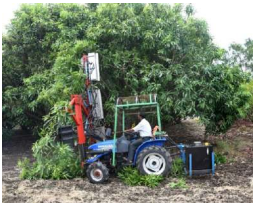
चित्र 3: छोटे ट्रैक्टर पर लगे हाइड्रोलिक प्रूनर का क्षेत्र मूल्यांकन
