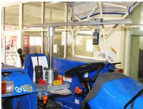
चित्र 3: ट्रैक्टर सीट पर स्थापित लेआउट माप उपकरण और एसआरपी
