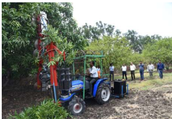
चित्र 3: छोटे ट्रैक्टर पर लगे हाइड्रोलिक प्रूनर का क्षेत्र मूल्यांकन
